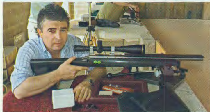
↑ Alberto Lenzi ha optato per un innovativo calcio Scoville, in legno di balsa, larice e sequoia, rivestito in carbonio.
