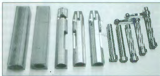
Staatstukken en grendels in diverse stadia van afwerking. Het getordeerde Stolle-uiteindelijk is wereldberoemd geworden.
