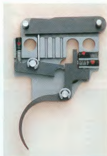
▲ピンのポジションがキーなのだ。トリガーが引かれトリガー上端がサード・レバーから外れシアが下降、ストライカーが前進したポジション。
