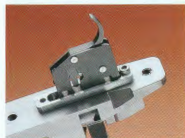
▲ピンのポジションがキーなのだ。トリガーが引かれトリガー上端がサード・レバーから外れシアが下降、ストライカーが前進したポジション。
