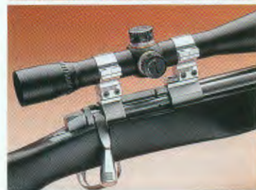
▲レミントン系のアクションなら基本的に使える。しかしそのものズバリの寸法で造られていないとトリガーの機能が完全に発揮できない。ストール・パンダ以外のアクションに装着されたKelbly'sトリガー。
